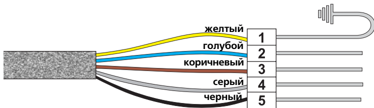
пятипроводная схема подключения электропровода на трехфазную сеть 380 В
