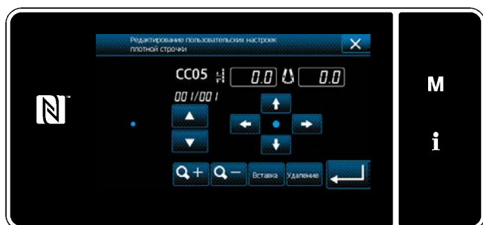
<Окно редактирования пользовательской настройки плотной строчки>
