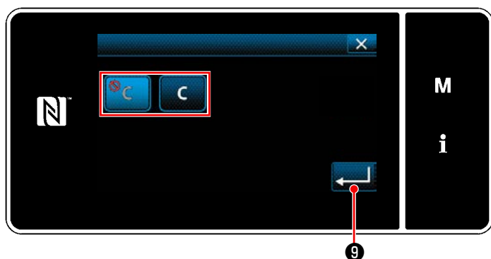
<Экран настройки сброса значений счетчика для предупреждения>
