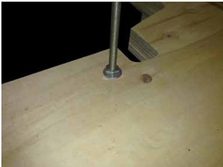
Крепим шпильки гайками
