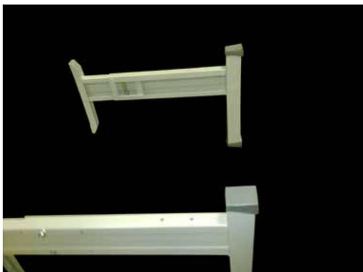
Устанавливаем поперечную планку
