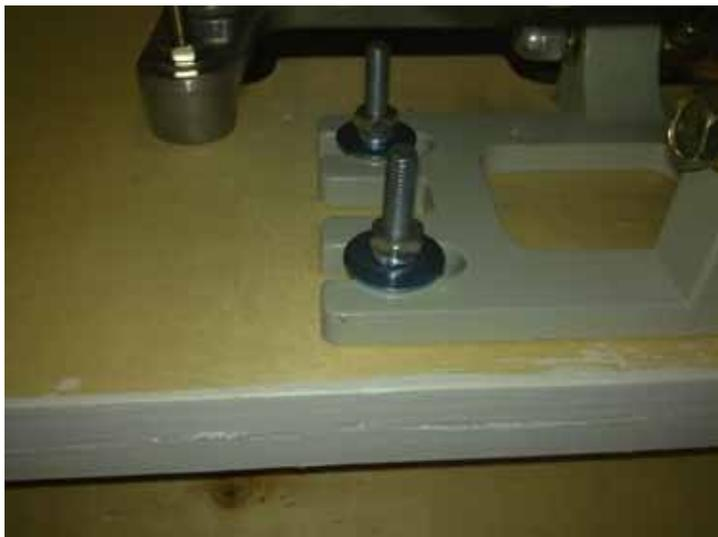
Выравниваем шкив двигателя по прорези деревянного поддона
