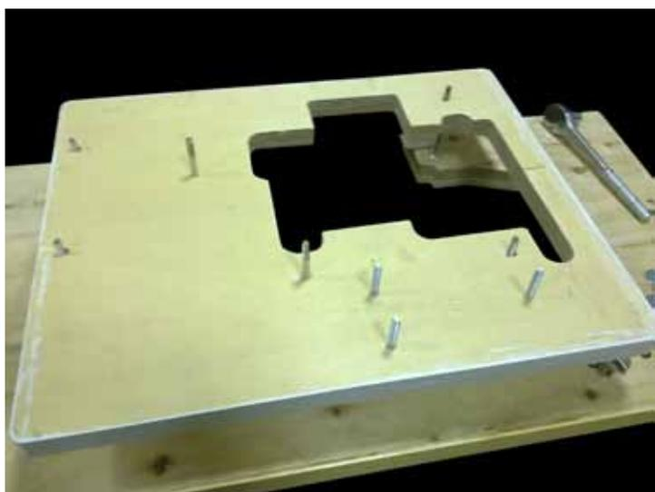
Надеваем поддон на шпильки
